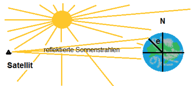
Abbildung 10: Die Menge des vom Satelliten reflektierten Sonnenlichtes ist proportional einer gewissen Fläche. Je größer der Satellit ist, umso heller muss er gesehen werden. Daraus ergibt sich eine zweite Möglichkeit zur Größenabschätzung.
